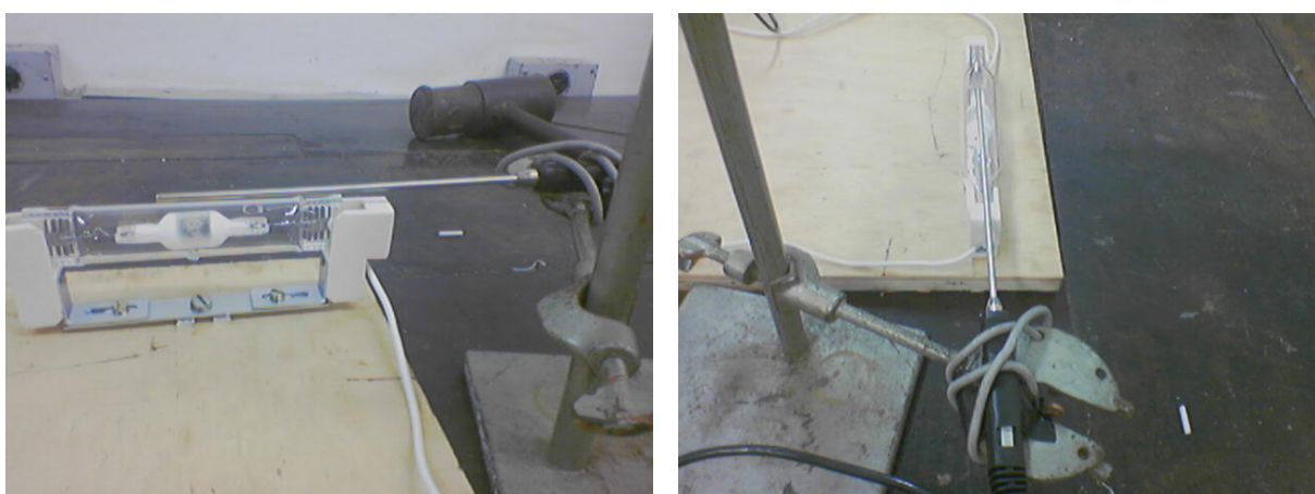
Figura 50 – Sonda do medidor PT100 posicionada próxima ao bulbo da lâmpada.
