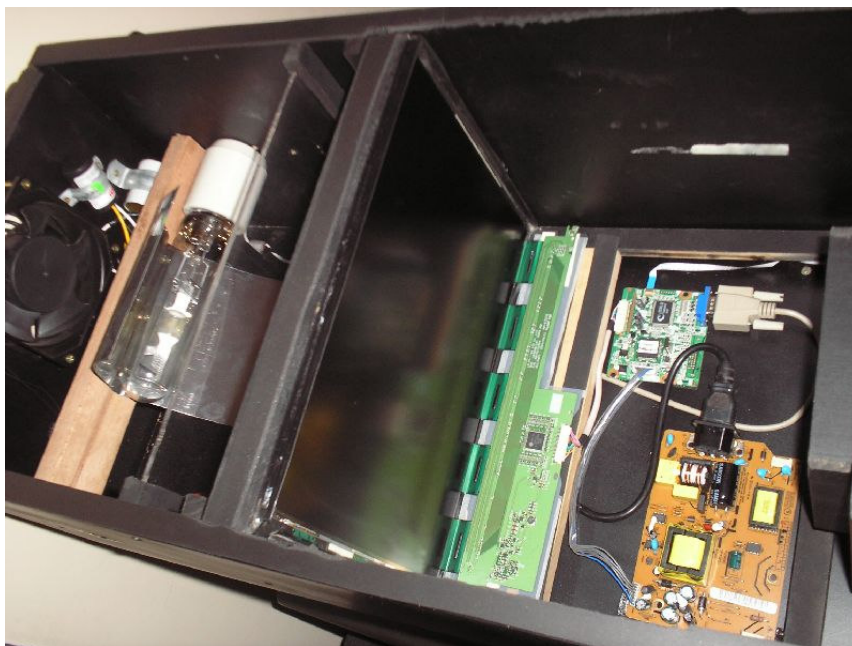
Figura 36 – Interior de um projetor utilizando LCD de 15" de diagonal. Fonte: DYI Labs Brasil. Disponível em < http://www.diy labs.com.br >. Acesso em 08 de set. de 2006.
