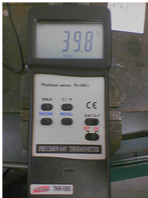
Figura 49 – Equipamento utilizado para a aferição da temperatura do bulbo da lâmpada, indicando uma temperatura qualquer.
