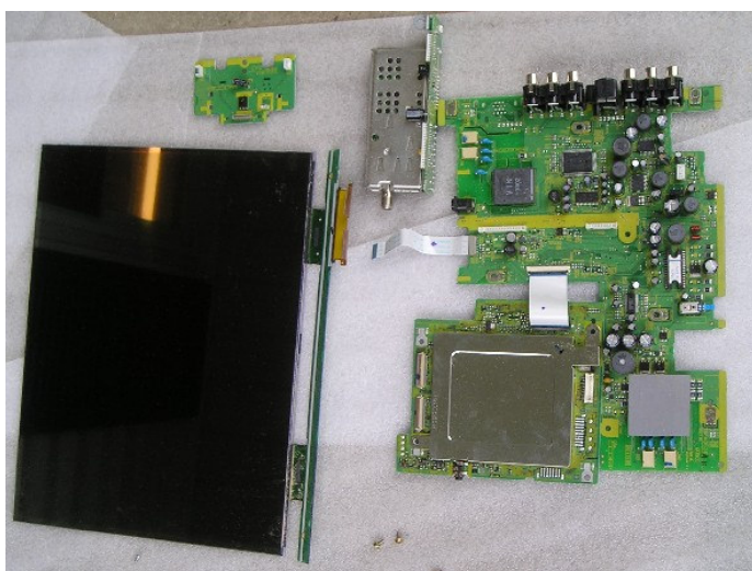
Figura 33 – Tela de LCD desmontada para utilização no projeto.
